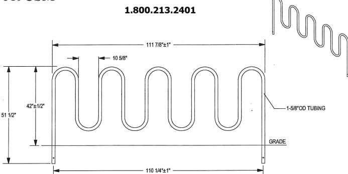
**ELEVATION VIEW** 9 LOOP - 11 BIKE CAPACITY
